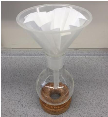
Abbildung 3: Rundkolben mit Plastiktrichter und Faltenfilter
