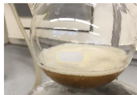
Abbildung 8 Das Gemisch siedet durch die entstehende Reaktionswärme.
