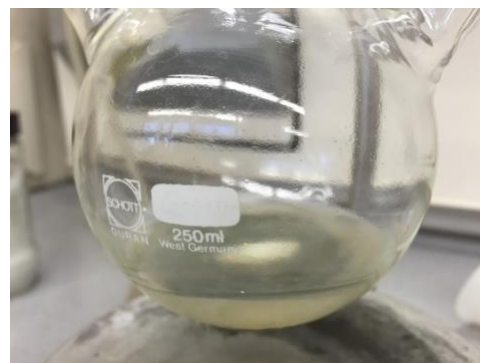
Abbildung 7 Trübung der Lösung nach Anspringen der Reaktion
