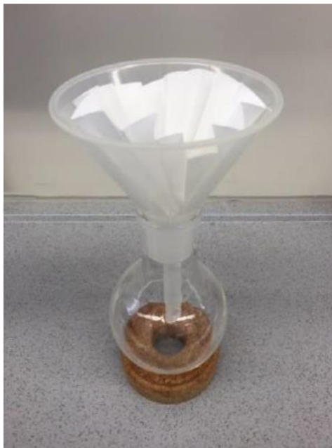
Abbildung 10: Filtration über Faltenfilter in einen abgewogenen Rundkolben
