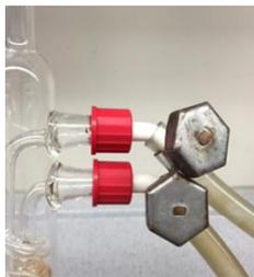
Einen Schlauch am einfachen Wasserhahn befestigen, den anderen mit einer Muffe beschweren und in das Waschbecken legen.
